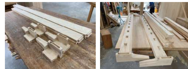
整組床組榫接結構 ▲ 結構非一般快速五金
