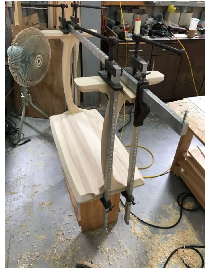
以全榫接方式施作 無金屬螺絲接合 使用水性乳膠強化接合
