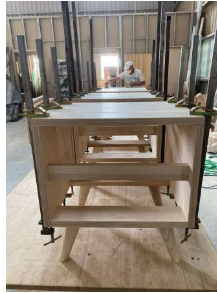
接合處用水性乳膠加壓乾燥
